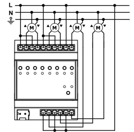
g Collegamento carichi (impiego EK-FG1-TP come attuatore 4 canali per controllo di azionamenti)
