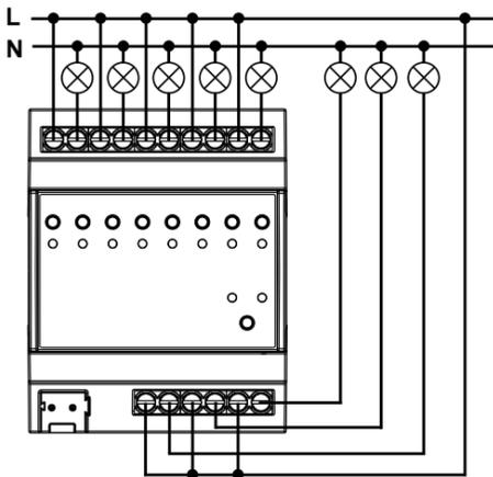
f Collegamento carichi (impiego EK-FG1-TP come uscita binaria 8 canali)
