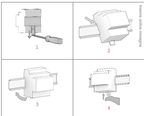
Per lo smontaggio dell'apparecchio, assicurarsi di avere scollegato le connessioni di rete e di avere disinserito il morsetto bus dal suo alloggiamento. Mediante un cacciavite far scorrere verso il basso il dispositivo di blocco e rimuovere l'apparecchio dalla guida profilata.
